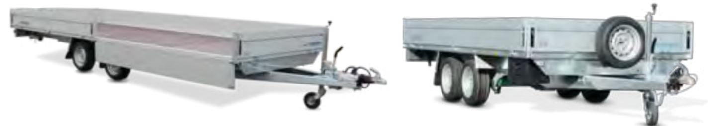
HLC 3560/210 mit Mittelrungen (da Kasteninnenlänge von 6.050 mm) HLC 3560/210 avec ranchers centraux (car longueur intérieure : 6.050 mm) HLC 3560/210 with centre posts (because of interior length of 6.050 mm)
