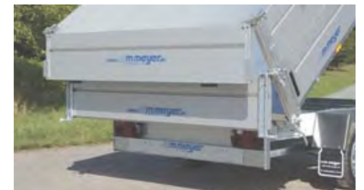
Zubehör: Alubordwandaufhöhung abnehmbar; untere Heckwand links: aufgeklappt; untere Heckwand rechts: aufgeschwenkt (bei HKC und HKCR) Option: ridelles supplémentaires en aluminium amovibles; illustration des 2 manières d'ouvrir la ridelle arrière basse (HKC et HKCR) Optional extra: additional aluminium side panels which can be taken off; illustration of the 2 ways of opening the lower rear panel (HKC and HKCR)
