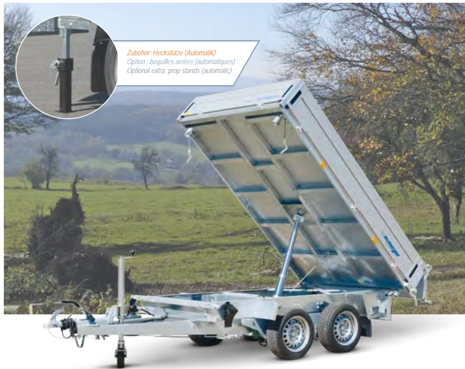
HKC 2726/155 Stützrad verstärkt, Chassis geschraubt, Kippbrücke geschweißt, Achtung: Auffahrschienen-schächte nicht lieferbar bei Kasteninnenlänge = 2.690 mm HKC 1526/155 Roue jockey renforcée, châssis boulonné, pont soudé ; important : boîtiers pour rampes non disponibles pour les tri-bennes = 2.690 mm HKC 1526/155 Reinforced jockey wheel, bolted chassis, welded tipping bridge; important information: storage shafts for skids not available for tippers = 2.690 mm
