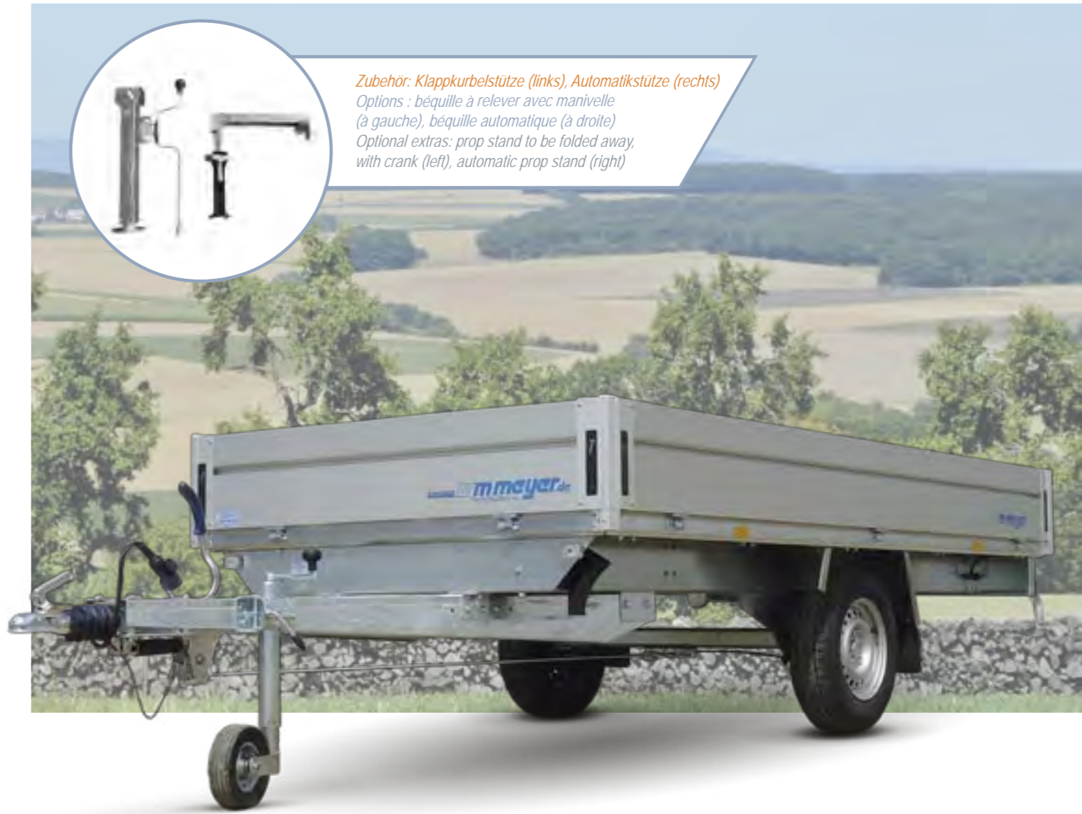
HLC 1336/170 Stützrad verstärkt, Aluminiumbordwände (Höhe: 330 mm), innenliegende Verschlüsse HLC 1336/170 Roue jockey renforcée, ridelles en aluminium anodisé (hauteur : 330 mm), serrures intégrées aux ridelles HLC 1336/170 Reinforced jockey wheel, aluminium side panels (height: 330 mm), fastenings integrated into side panels
