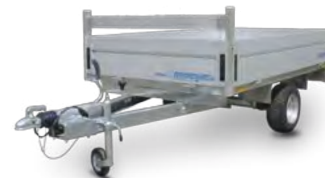
HLN 1323/141 Zubehör: H-Gestell aus Aluminium HLN 1323/141 Option : porte-échelle en aluminium HLN 1323/141 Optional extra: aluminium ladder rack
