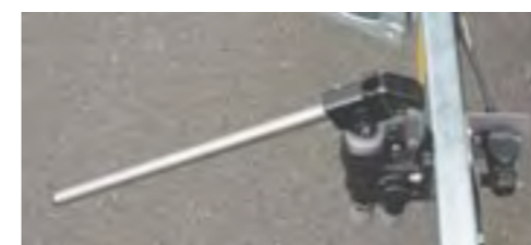
HKD 3527/170 Heckwand pendelbar, Elektropumpe mit Nothandpumpe und Batterie (Ladeeinrichtung vorhanden) HKD 3527/170 Ridelle arrière oscillante, pompe électrique avec pompe manuelle d'urgence et batterie (prise pour chargeur montée) HKD 3527/170 Oscillating rear panel, electric pump with manual emergency pump, battery and charging plug
