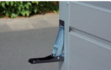
Verschluß: geschlossen und geöffnet Serrure intégrée : fermée et ouverte Fastening: closed and open
