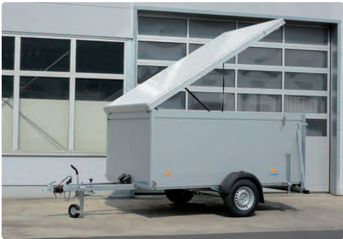
B 1530/185 Sonder Zub.: Stützen, höhere Bordwände, Sandwichaludeckel B 1530/185 Spéciale Options : béquilles, ridelles plus hautes, hardtop B 1530/185 Special Opt.: prop stands, increased side panel height, hardtop
