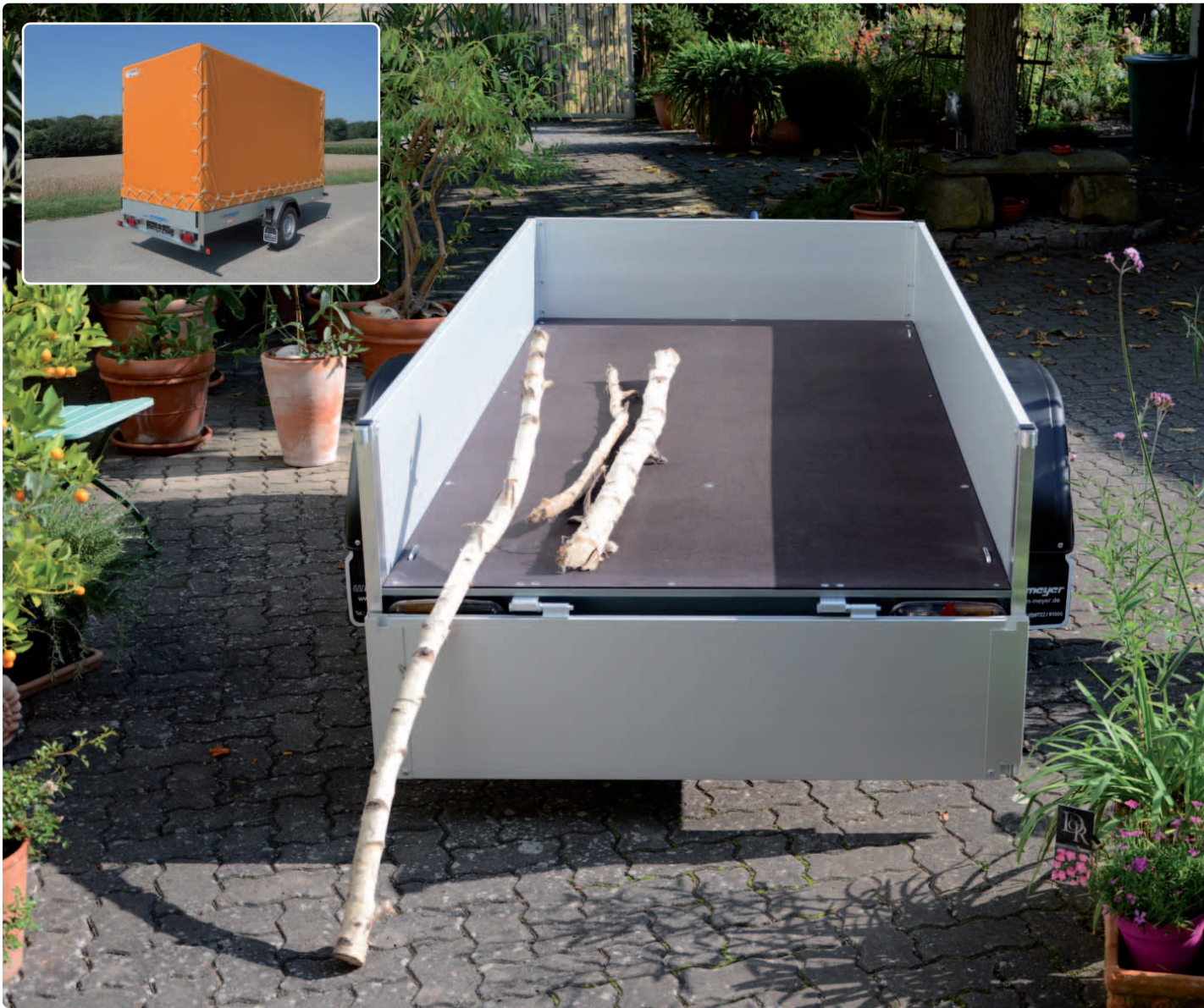
B 1325/126 Siebdruckholzboden, Aluminiumbordwände (Stärke: 25 mm, Höhe: 350 mm) ; kleines Bild: B 1335/151 Zubehör: Plane und Spriegel B 1325/126 Plancher en bois antidérapant imperm., ridelles en alu (épais. : 25 mm, H : 350 mm) ; petite photo : B 1335/151 Opt. : bâche et ossature en alu B 1325/126 High-density plywood platform, alum. panels (width: 25 mm, height: 350 mm) ; small picture: B 1335/151 Optional extras: canvas top and alumi-
