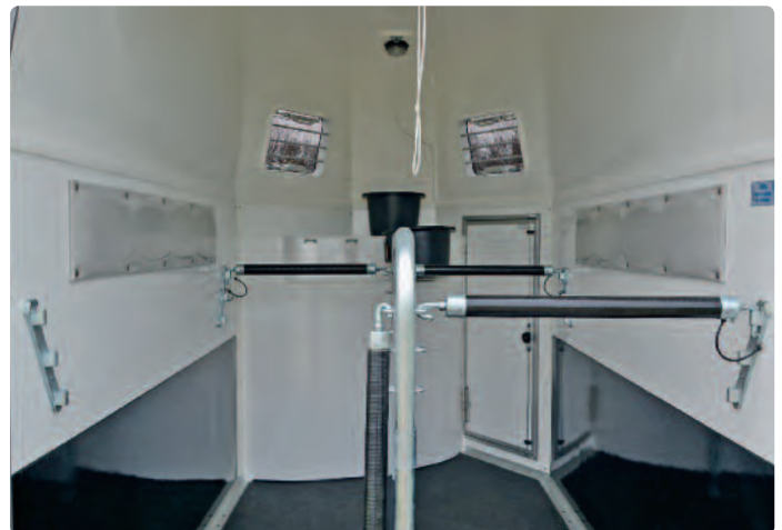
Serie: Trittschutz, Sattelkammer Groß, 2 aushängbare Futterkübel, Polster Série : pare-bottes, Grande sellerie, 2 seaux mangeoire, rembourrage lat. Standard: kick protection, Grand saddle chamber, 2 feed buckets, paddings
