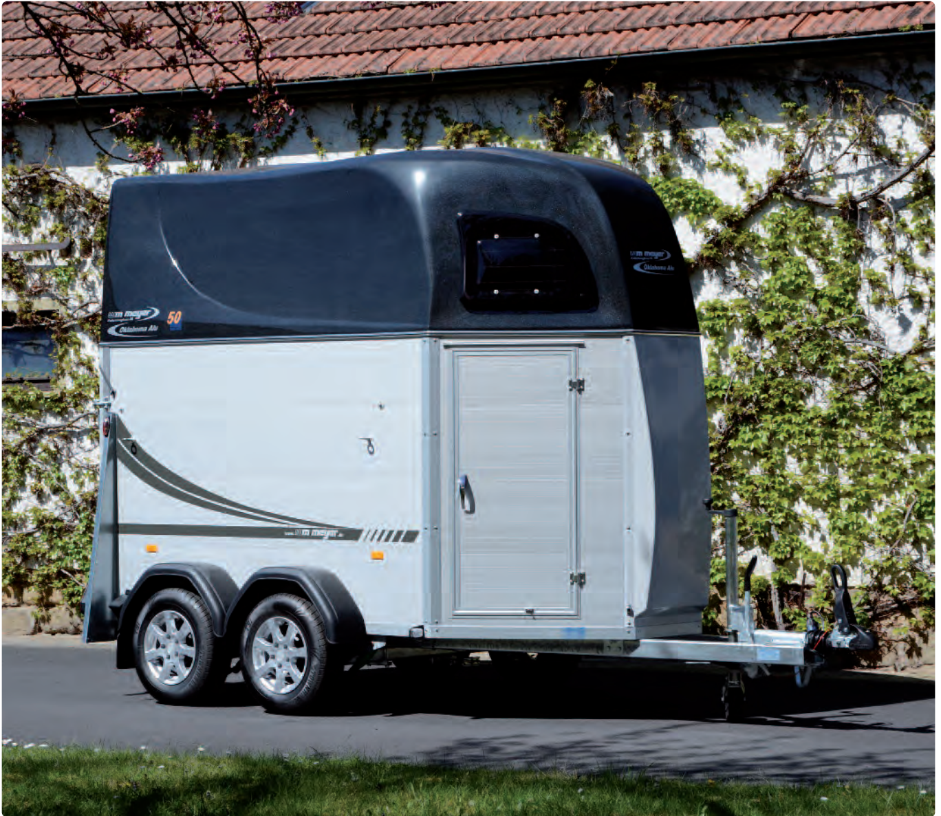
Oklahoma Alu Plus Innenlänge: 3.250 mm, Innenhöhe: 2.470 mm, Kunststoffeinzelnradkotflügel, Aluminiumfelgen, Zubehör: Antischlingerkupplung Oklahoma Alu Plus Longueur intérieure : 3.250 mm, hauteur int. : 2.470 mm, garde-boues individuels en plastique, jantes en alu, opt. : stabilisateur de sécurité Oklahoma Alu Plus Internal length: 3,250 mm (all models), internal height: 2,470 mm, separate plastic mudguards, aluminium rims, optional: anti-sway coupling
