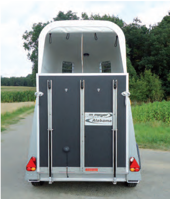
Heckrahmen, Rampenscharnier und -träger Edelstahl Bâti arrière, charnières de pont et supports en inox Rear frame, ramp hinge and ramp supports made of stainless steel
