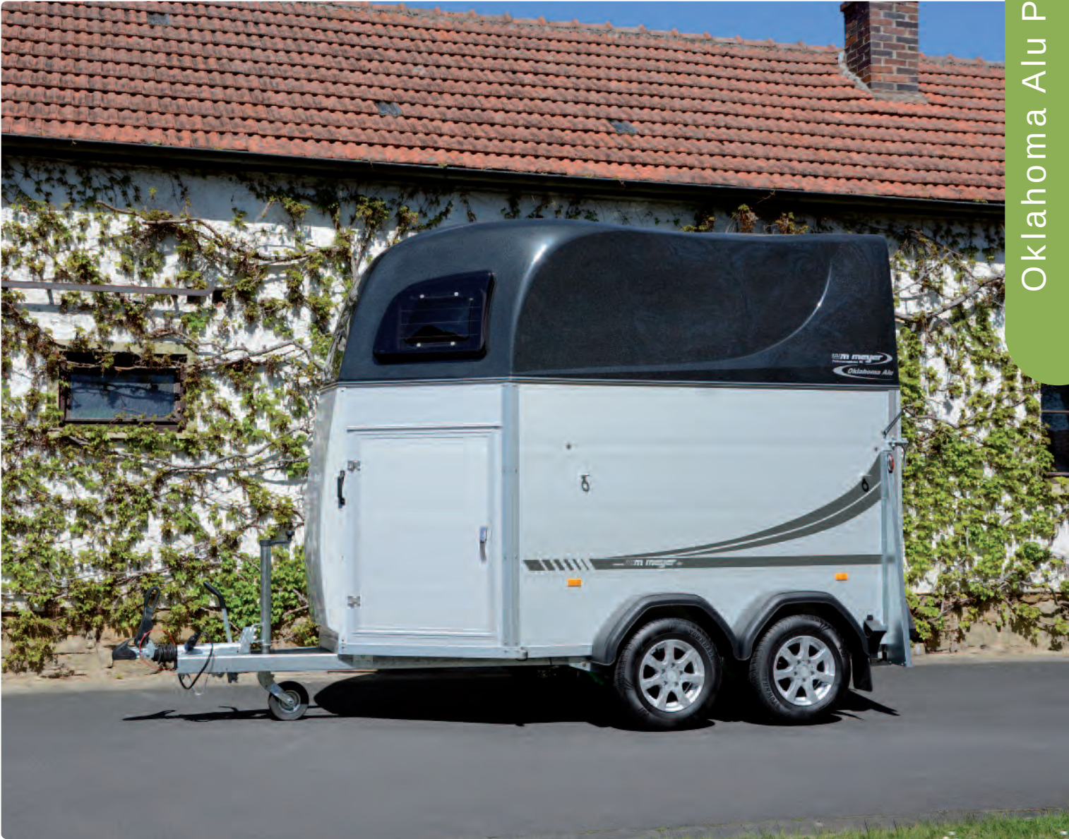
Stützrad verstärkt (klappbar), Aluminiumwände, Sattelkammer Groß, Polyesterhaube (schwarzmetallic), Zubehör: Antischlingerkupplung Roue jockey renforcée (automatique), panneaux en aluminium, Grande sellerie, hardtop en polyester (noir métallisé), option : stabilisateur de sécurité Reinforced jockey wheel (automatic), aluminium side panels, Grand saddle chamber, polyester hardtop (black metallic), optional extra: anti-sway coupling
