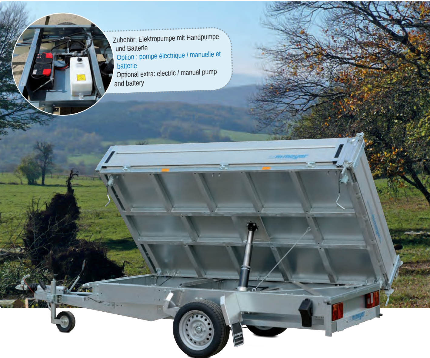
HKC 1526/155 Stützrad verstärkt, Chassis geschraubt, Kippbrücke geschweißt, Achtung: Auffahrschienenschächte nicht mehr lieferbar HKC 1526/155 Roue jockey renforcée, châssis boulonné, pont soudé, important : supports de rampes plus disponibles HKC 1526/155 Reinforced jockey wheel, bolted chassis, welded tipping bridge, important information: storage shafts for skids no longer available
