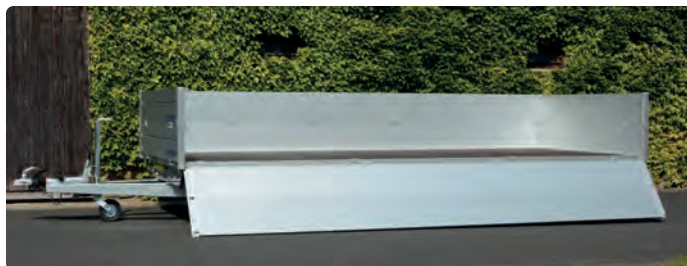
HLC 3051/210 Zub.: Bordwanderhö. (Aufgeklappte Wände berühren Boden.) HLC 3051/210 Opt. : ridelles supplément. (Ridelles ouvertes touchent le sol.) HLC 3051/210 Opt.: add. side panels (which, when opened, touch the ground)
