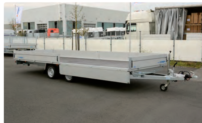
HLC 3560/210 Mit Mittelrungen (da Kasteninnenlänge von 6.050 mm) HLC 3560/210 Avec ranchers centraux (parce que long. int. : 6.050 mm) HLC 3560/210 With centre posts (because of interior length of 6,050 mm)
