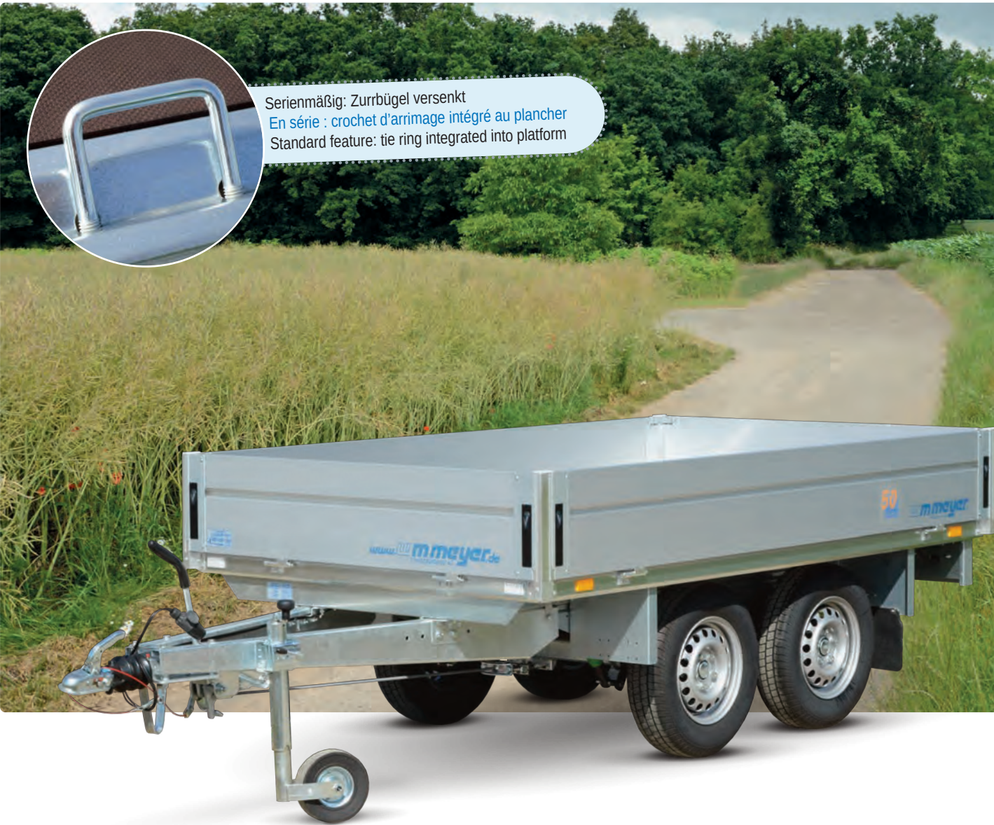
HLN 2026/151 Aluminiumbordwände (Höhe: 330 mm), Zubehör: 100-km/h-Ausführung HLN 2026/151 Ridelles en aluminium anodisé (hauteur : 330 mm), option : kit « rouler plus confortablement » HLN 2026/151 Aluminium side panels (height: 330 mm), optional extra: smooth-ride kit
