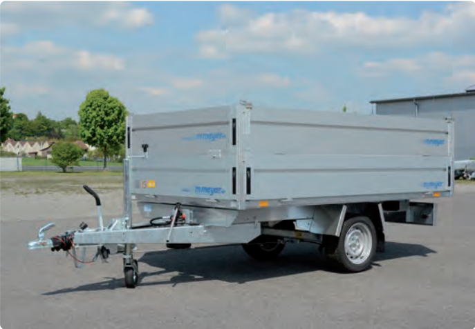
Zubehör: Stützrad verstärkt, klappbar, mittig, Aluminiumbordwanderhöhung Option : roue jockey renforcée, automatique, au milieu, ridelles suppl. en alu Option: reinfor. jockey wheel, autom., in the middle, add. alum. side panels
