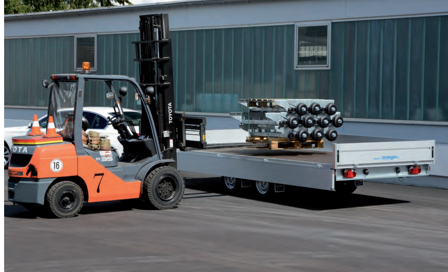
HLC 2751/210 Aluminiumbordwände eloxiert, 4 Seiten klapp- und aushängbar, leichte Be- und Entladbarkeit von drei Seiten HLC 2751/210 Ridelles en aluminium anodisé, toutes les ridelles ouvrables et enlevables, facile à charger et décharger de trois côtés HLC 2751/210 Anodised aluminium side panels, all side panels can be opened and removed, easy to load and unload from three sides
