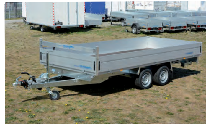
HLC 3541/186 Zubehör: H-Gestell aus Aluminium HLC 3541/186 Option : porte-échelle en alu HLC 3541/186 Optional extra: aluminium ladder rack
