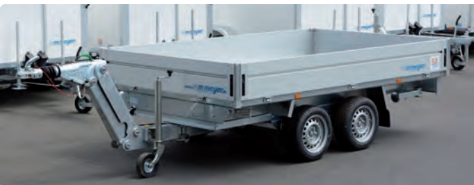
HLC 3531/186 Zubehör: Deichsel höhenverstellbar (Rahmen verstärkt) HLC 3531/186 Option : timon réglable en hauteur (châssis renforcé) HLC 3531/186 Option: drawbar adjustable in height (reinforced chassis)
