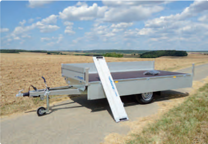
Alle Bordwände abnehmbar, Zubehör: Ladungssicherungsnetz (verpackt) Toutes les ridelles peuvent être enlevées, option : filet d'arrimage (emballé) All side panels can be removed, optional extra: trailer net (in packaging)
