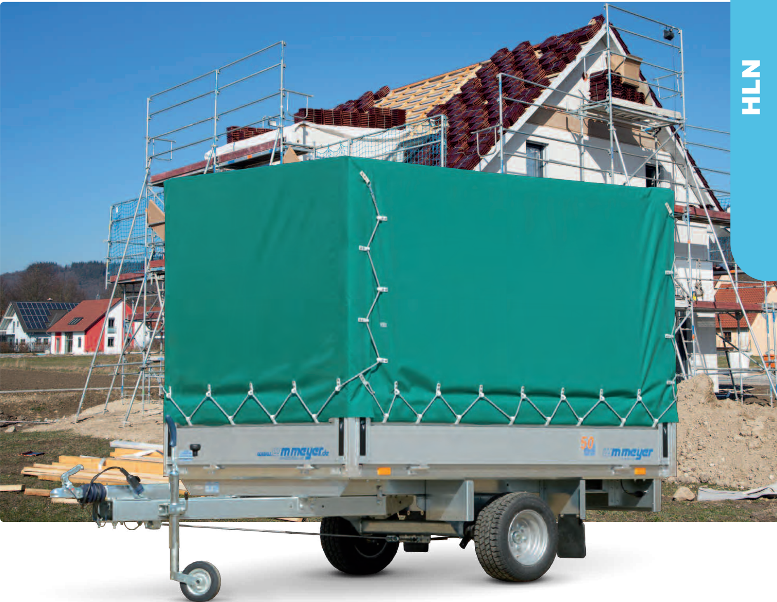
HLN 1323/141 Geschraubtes Chassis; Zubehör: Plane und Aluminiumspriegel HLN 1323/141 Châssis boulonné ; options : bâche et ossature en alu HLN 1323/141 Bolted chassis; optional extra: canvas top, aluminium support
