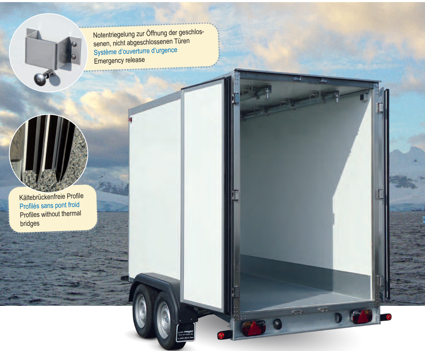
AZK 2730/156 60/60 K Aluscheuerleiste dreiseitig (Höhe: 250 mm), Heckrahmen in V2A, Zubehör: Fleischgehänge AZK 2730/156 60/60 K Plinthe en alu (3 côtés, hauteur : 250 mm), bâti arrière en inox, options : supports de viande AZK 2730/156 60/60 K Aluminium skirting board (3 sides, height: 250 mm), rear frame made of stainless steel, optional extras: meat supports
