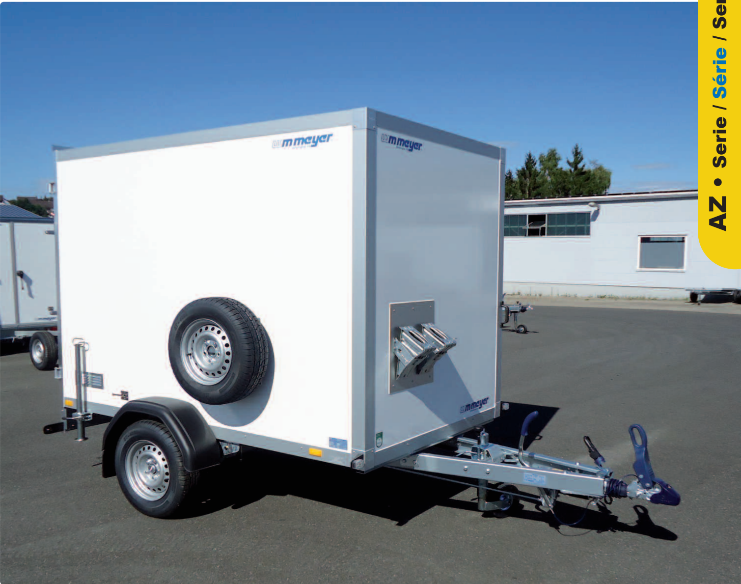
AZ 1325/151 Serie 70 Zubehör: u. a. Antischlingerkupplung, Stützradtraverse, Lüftungslamelle, Unterlegkeile, Ersatzrad AZ 1325/151 Série 70 Options : stabilisateur pour tête d'attelage, traverse pour roue jockey, aération, cales de roue, roue de secours, etc. AZ 1325/151 Series 70 Optional extras: sway-control coupling, jockey wheel support, ventilation vent, wheel chocks, spare wheel, etc.
