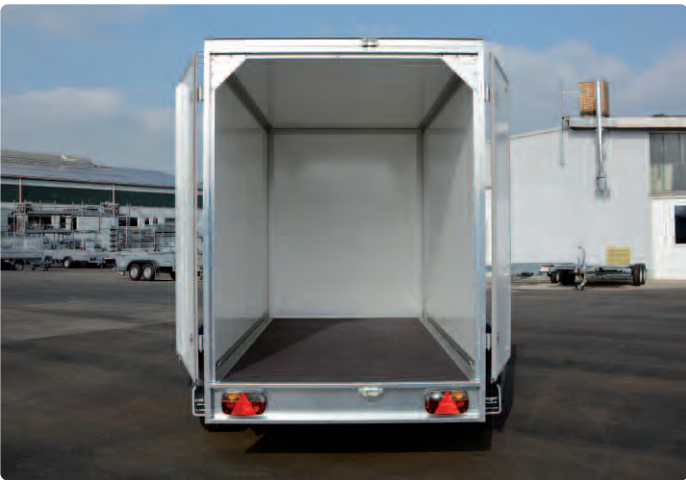
AZ 2030/151 Serie 30 Siebdruckholzboden (18 mm) AZ 2030/151 Série 30 Plancher en bois antidérapant imperméabilisé AZ 2030/151 Series 30 High-density plywood platform
