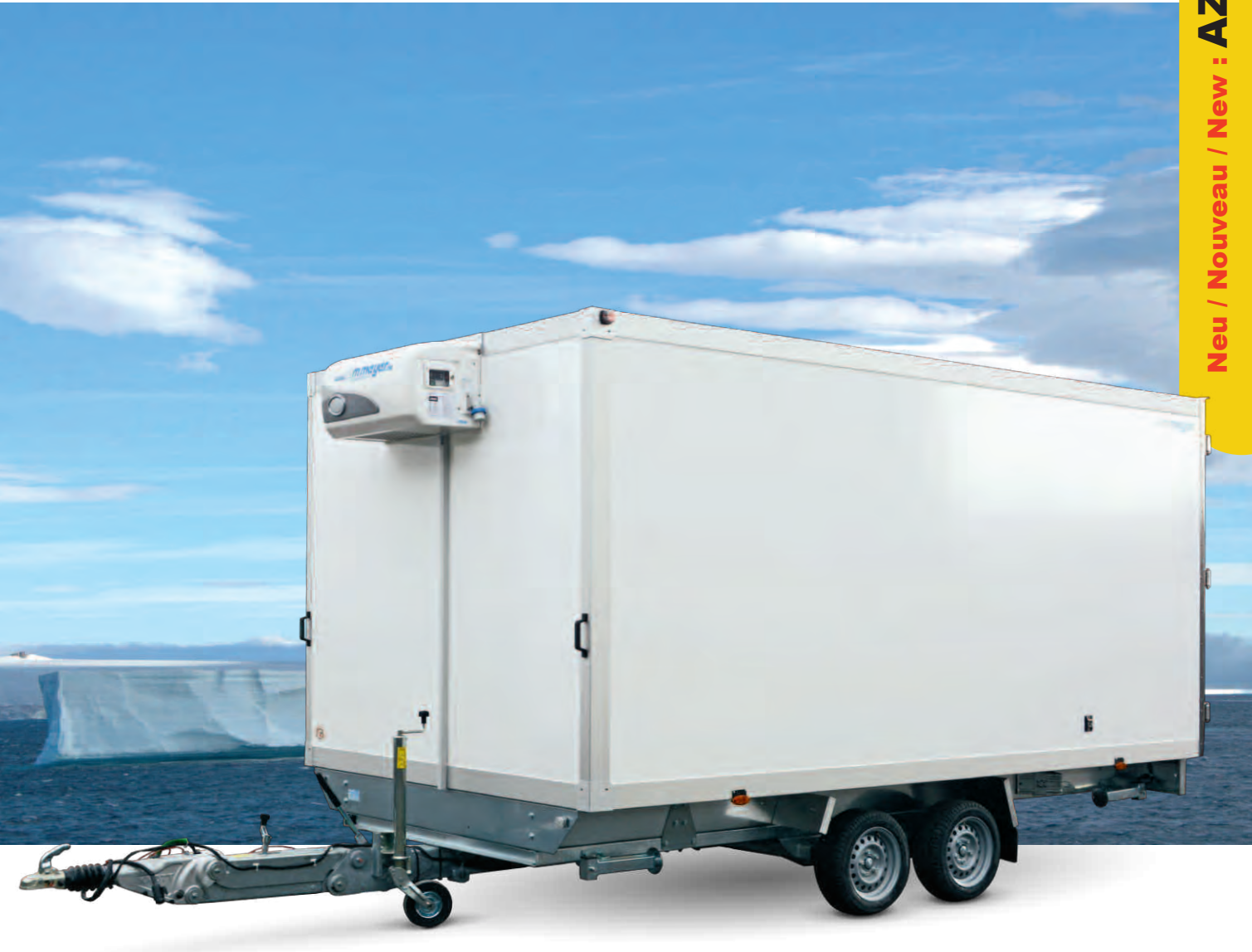
AZKHLC 3544/203 60/60 K Sonderkühlkoffernhänger Kühlung WMK 7, Zubehör: höhenverstellbare Deichsel, Klappkurbelstützen AZKHLC 3544/203 60/60 K Fourgon spécial frigorifique Groupe froid WMK 7, options : timon réglable en hauteur, béquilles à relever (avec manivelle) AZKHLC 3544/203 60/60 K Special chiller box van Cooler unit WMK 7, optional: drawbar adjustable in height, prop stands to be folded away (with crank)
