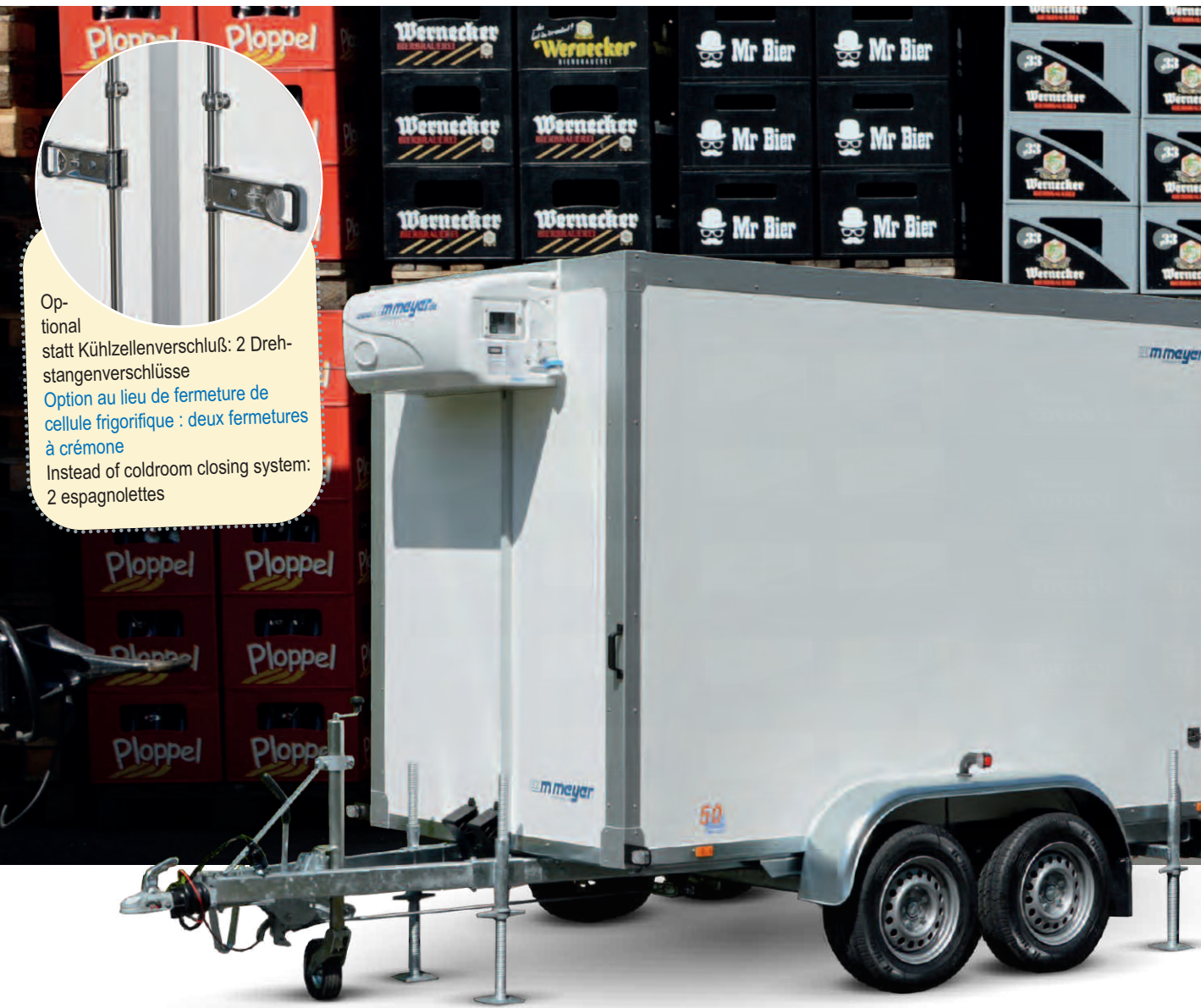
AZKF 2730/155 Stützrad verstärkt, Aufbau Sandwichpolyester, Sonderausstattung: 4 Klappkurbelstützen AZKF 2730/155 Roue jockey renforcée, panneaux, porte et toit en polyester sandwich, équipements spéciaux : 4 béquilles à relever (avec manivelle) AZKF 2730/155 Reinforced jockey wheel, side panels, door and roof made of sandwich polyester, special feature: 4 prop stands to be folded away (with crank)
