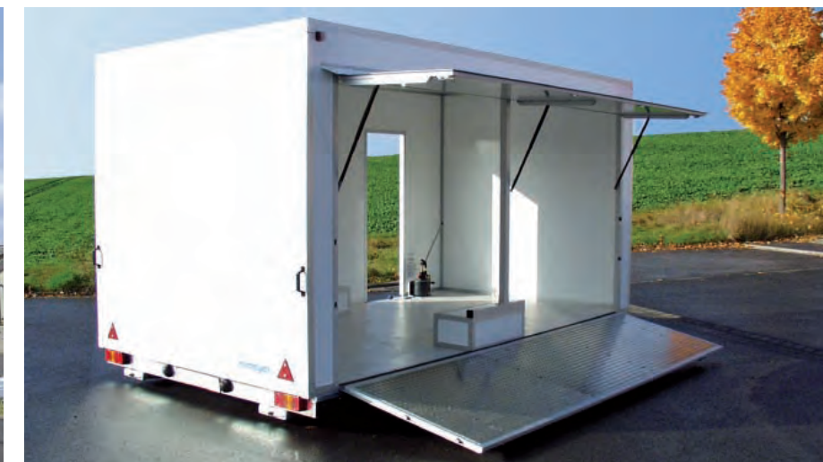
VK 2050/220 Profi Sonder Senklift (Absenkung auf ca. 25 cm über Boden) VK 2050/220 Profi Spéciale Surbaissante (distance sol - remorque : 25 cm env.) VK 2050/220 Profi Special Elevating (can be lowered to appr. 25 cm above ground)
