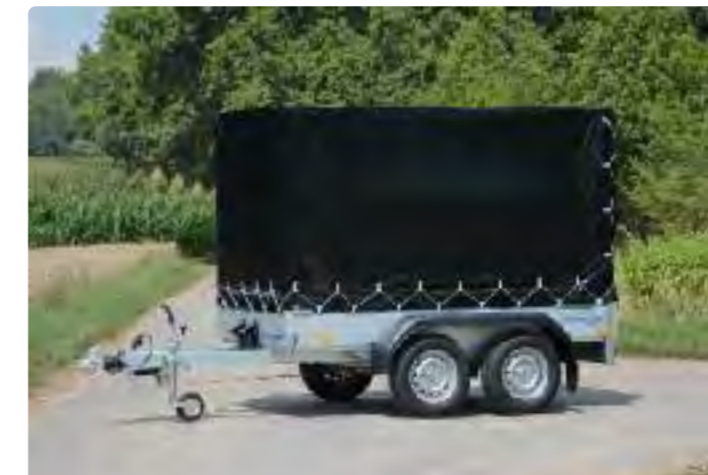
BT 2025/126 Zubehör: Plane und Aluspriegel (Höhe: 1.400 mm) BT 2025/126 Option: bâche et ossature en aluminium (hauteur: 1.400 mm) BT 2025/126 Optional extra: canvas top, aluminium support (height: 1,400 mm)
