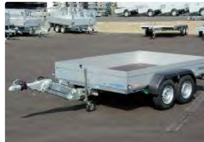
BT 3030/200 Zubehör: 100 km/h, Deichsel höhenverstellbar BT 3030/200 Options: kit « rouler plus confortablement », timon réglable BT 3030/200 Optional extras: smooth-ride kit, adjustable drawbar
